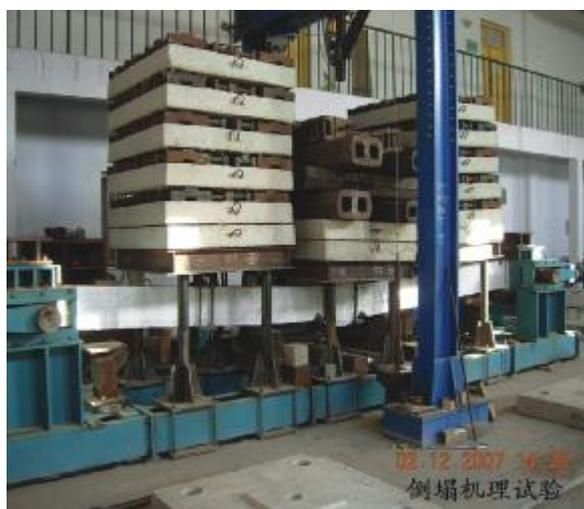
过钢筋混凝土框架结构竖向连续倒塌机理、连续倒塌过程中的动力响应和框架梁内拱效应研究，提出了抗连续倒塌设计方法及构造措施；建立了地下管道破坏分
