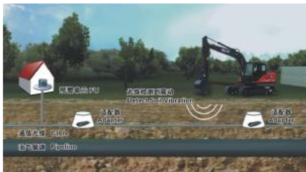
光纤管道安全预警系统原理
