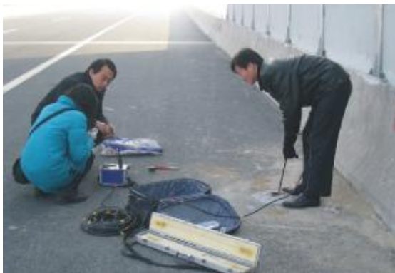
土工格栅加筋土挡墙水平位移测试
