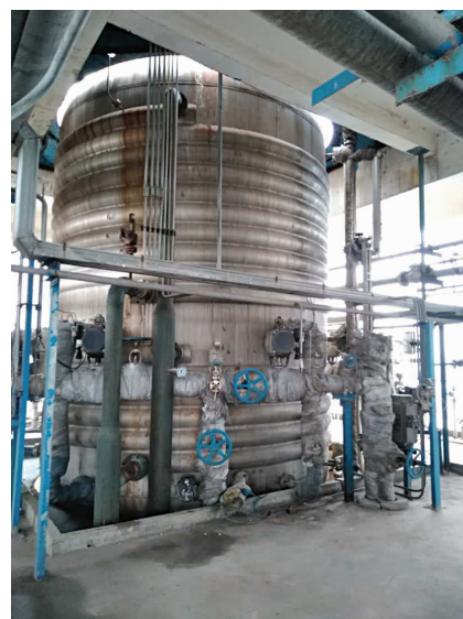
氨脲化金属膜浆态床工业化反应分离釜
