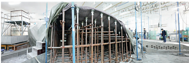
具有国际领先水平的尾矿库溃坝模型试验系统
