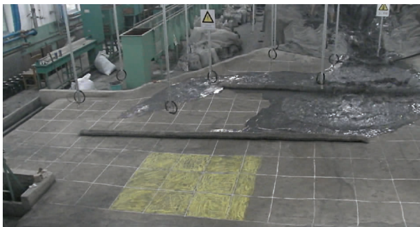
正在进行的溃坝泥石流拦挡导流试验研究
