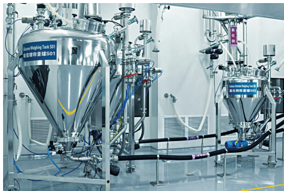
负压密闭循环上料联合洁净热风吹送系统,自动化、密闭化、定量精度高、密闭输送无污染。人为误差降为 0,交叉污染降为 0。
