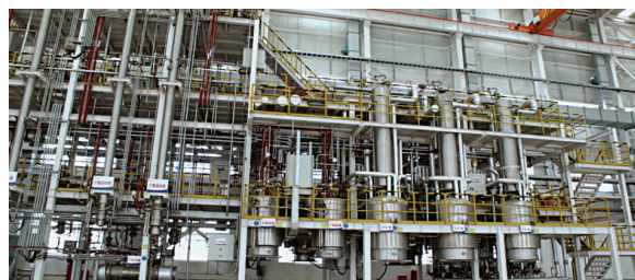
特定杂质的靶向脱除与共性杂质的共脱除的精馏装置
