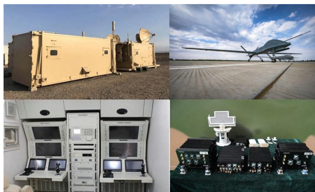
无人机视距测控系统设备组图
