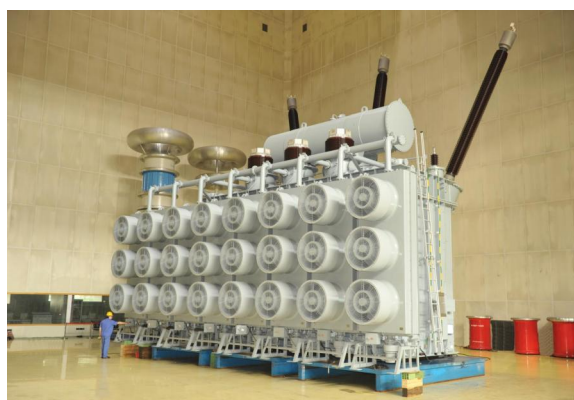
1000kV 特高压变压器
