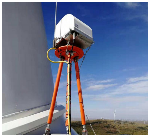
用于风速和风向预测的激光雷达
