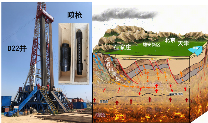
水力喷射装置及热储改造设备
